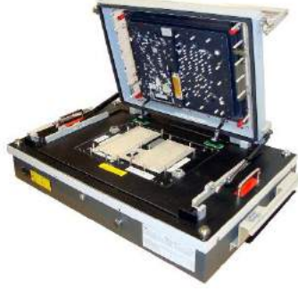
Resim 3.153. Bir ATE cihazı test platformu (fixture) görünümü.
